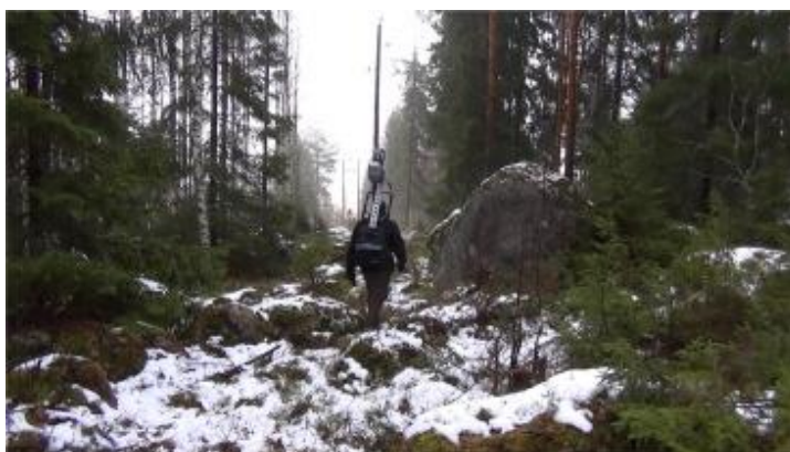
6-сурет. Лазерлік сканерлеу жүйесі (FGI AkhkaR2) бар рюкзакпен PLS электр желісі дәлізін сканерлеу.
