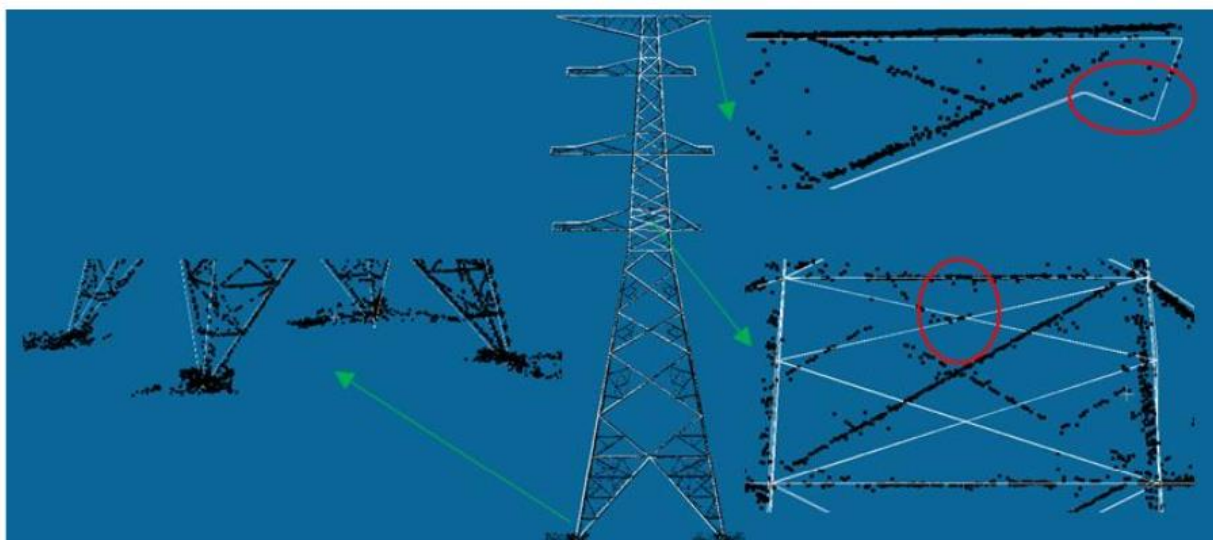
71-сурет. 1 типті шуды жойғаннан кейін тіректі қалпына келтіру нәтижесі.
